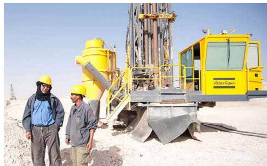
De svenska bormaskinerna 84 ton Pit Viper PV275 används för att göra spränghål, så att fosfatmalmen kan sprängas loss.
